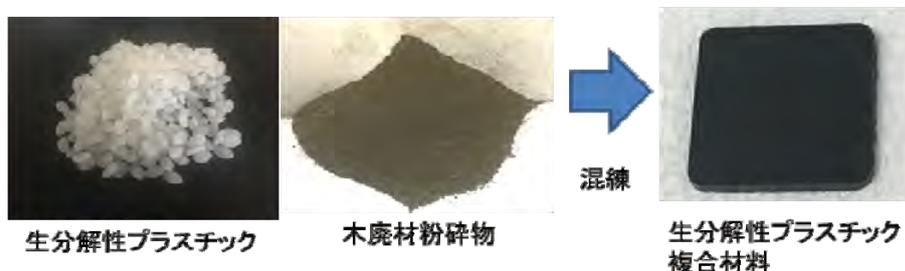
力学的性質向上、コスト低減のため、充填剤として木廃材粉砕物を生分解性プラスチックに添加
