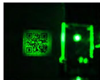
ガラスに記録した“見えない”ホログラム。見た目は一般的なガラスと見分けがつかないが(左)、記録した点にレーザーを照射するとホログラムが読み出せる(右)。
