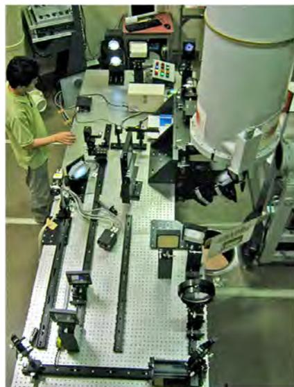
(左)開発中の補償光学装置。1m×3mの台の上に可変形鏡や波面センサが配置されている。
