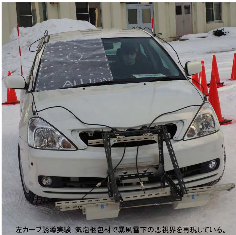
左カーブ誘導実験: 気泡梱包材で暴風雪下の悪視界を再現している。
