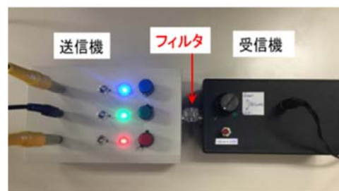
波長多重光通信を学ぶための可視光通信システムの設計・製作
