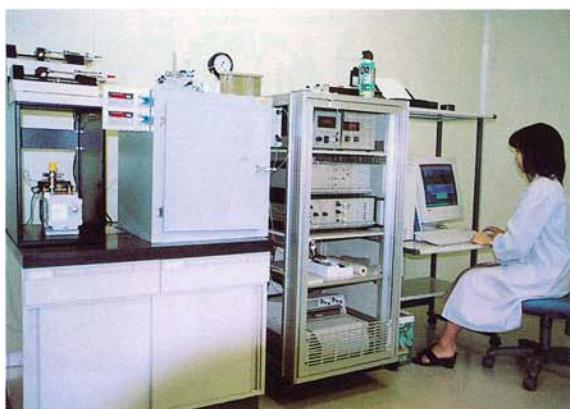
● 多孔性固体試料評価システム
