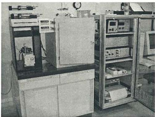
図4. 流通式微少熱量計
