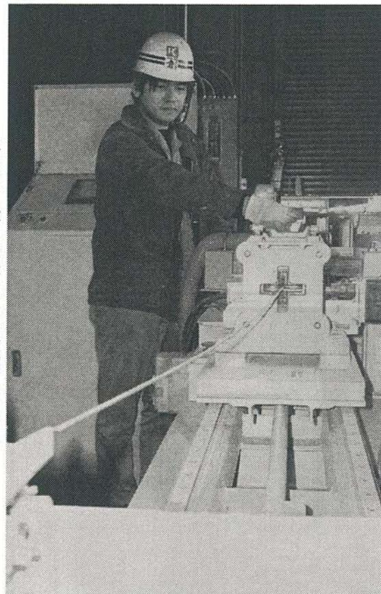
水をはじく溶射用の複合ワイヤの製造機=倉本鉄工所
