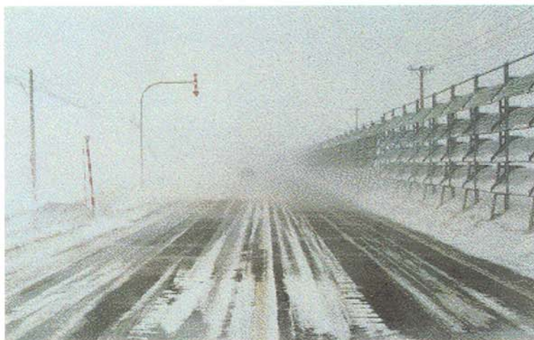
図2 野外観測試験（手前が開発柵で後方が従来柵、道路上の視程に明確な違いが認められる）
