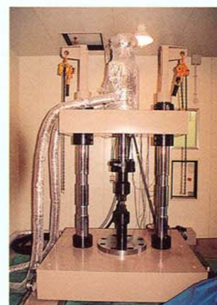
低温材料載荷装置 (低温室3)
