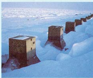
(流水海域でのコンクリート暴露実験)
