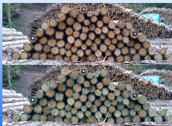
丸太の自動径級計測
