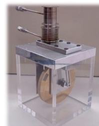
災害時用の小型発電機
