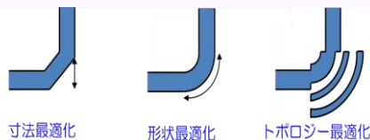
図1 最適化法に基づく設計例
