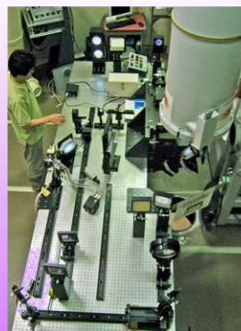
(左) 開発中の補償光学装置。1m × 3mの台の上に可変形鏡や波面センサが配置されている。
